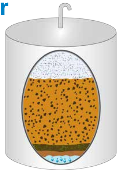
Depósito de almacenamiento contaminado con suciedad, agua y desarrollos microbianos.
